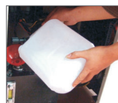
倒入液压油，关盖和柜门
